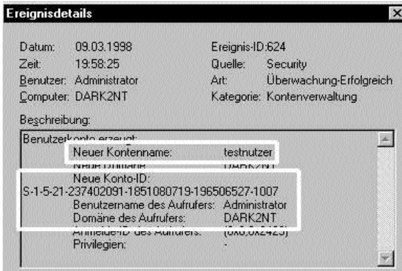
Abbildung 48: Kontenverwaltung neues Benutzerkonto
