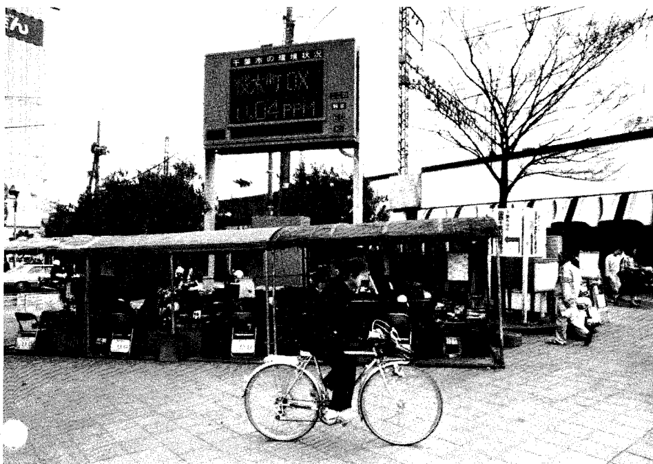
Solche elektronischen Schautafeln zeigen die Luftbelastung durch \text{NO}_2 , \text{SO}_2 , \text{CO} und \text{O}_x (letzteres zur Information über photochemischen Smog) sowie die Lärmbelastung in dB an.
