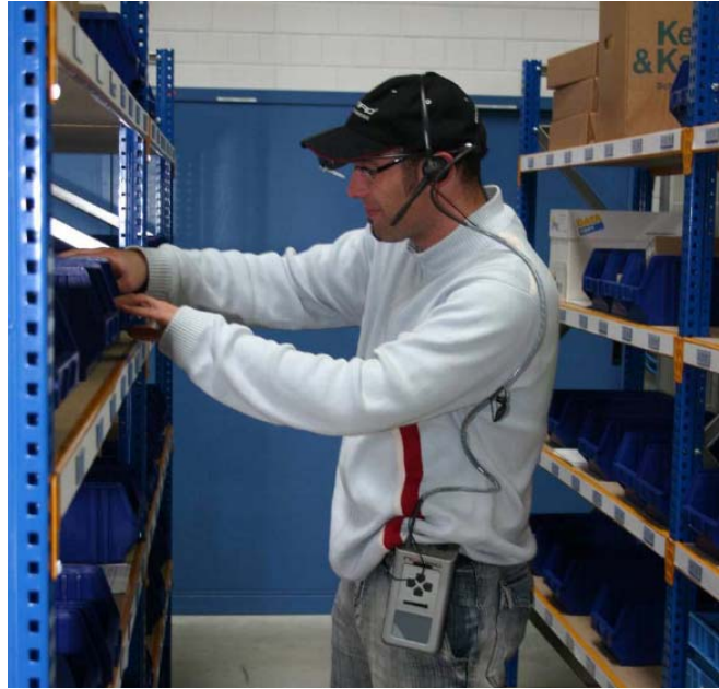
Abbildung 7: Beispiel eines Assistenzsystems - Datenbrille und Headset zur Unterstützung einer manuellen Kommissionierung (Günthner 2009, 111)
