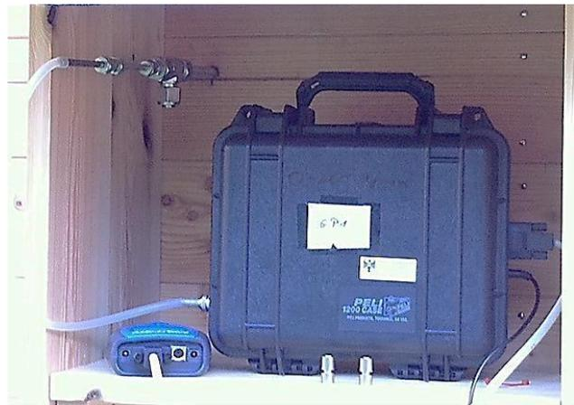
Abbildung 13: Luftprobenahme am Beispiel mit Tenax TA Sorptionsröhrchen
