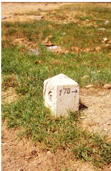
Figur 6: Nytt grensemerke i betong.
