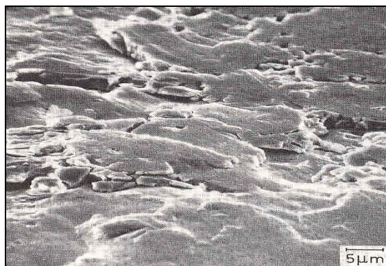
Abbildung 12 Typische Erscheinungsform der Adhäsion (REM)
